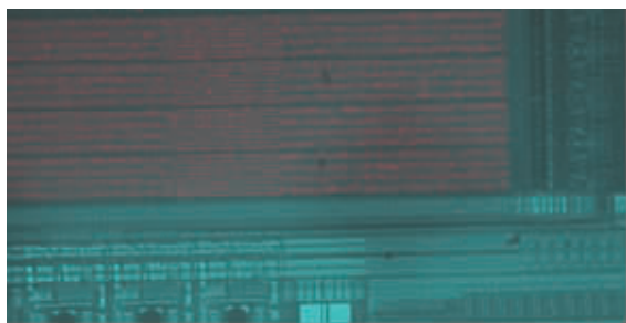
图 5 商用电路总剂量辐照后 EMMI 测试图
